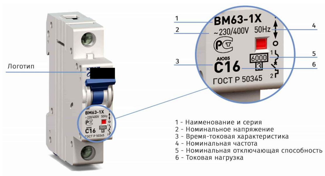
Рисунок 2. Пример маркировки АВ
